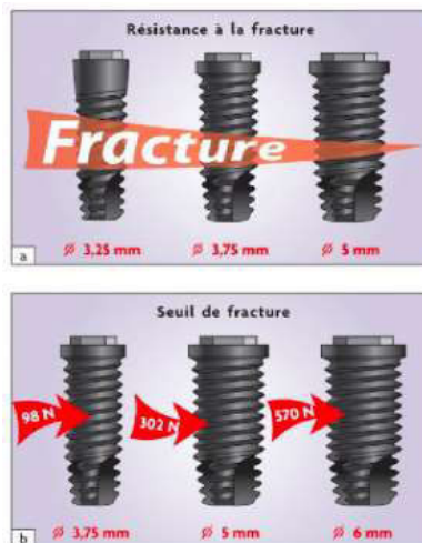
Figure 76: risques biomécaniques et résistance à la fracture en fonction du diamètre implantaire (source Davarpanah 2012)
