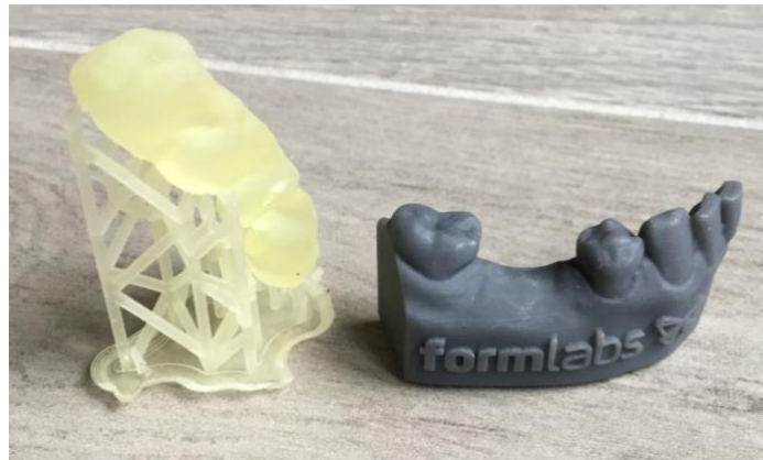
Figure 20 : Photographie d'un guide chirurgical implantaire imprimé par stéréolithographie avec son échafaudage support et le modèle dentaire correspondant
