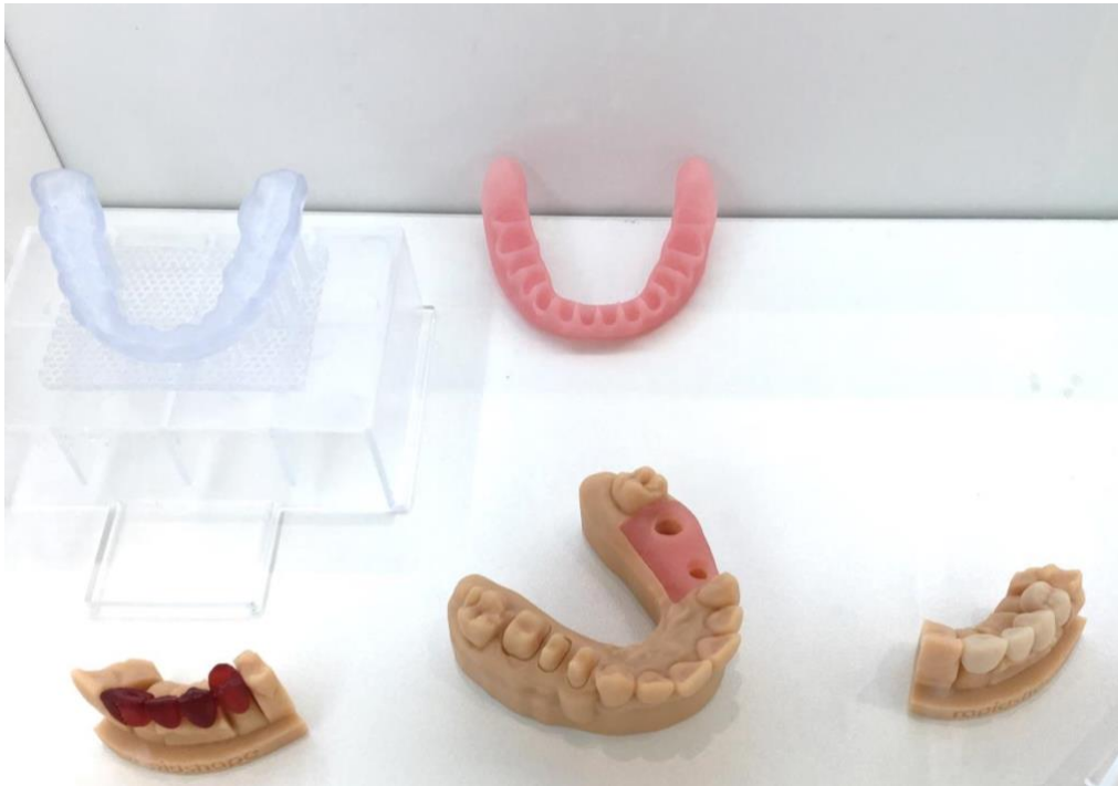
Figure 4 : Photographie des différents types de résine pouvant être utilisée pour les imprimantes DLP ou SLA
