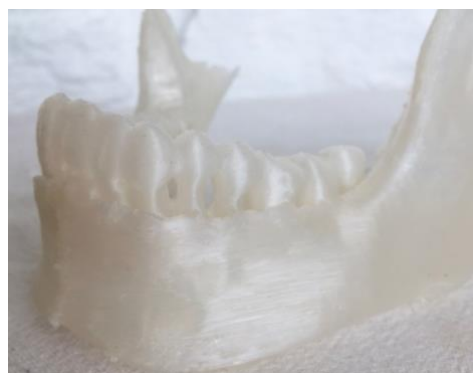
Figure 18 : Photographie d'une mandibule imprimée par dépôt de fil fin fondu, résolution des couches de 100µm, les différentes couches sont visibles à l'œil nu lors de l'observation.
