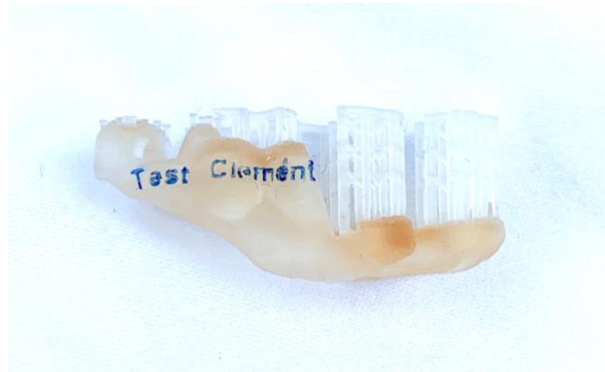
Figure 21 : Photographie d'un guide chirurgical imprimé avec l'identité du patient dessus
