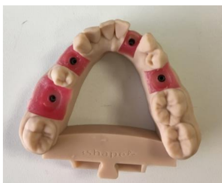
Figure 3 : Photographie d'un modèle dentaire imprimé avec l'utilisation d'une imprimante 3D DLP et présence de résine simulant la gencive
