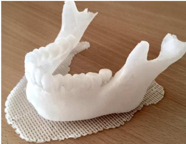
Figure 19 : Photographie d'une mandibule imprimée par dépôt de fil fin fondu avec le « raft », maillage support pour l'impression
