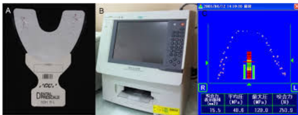
Figure 21 : présentation du système Dental Prescale mesurant la force occlusale (source : Choi et coll., 2014)
