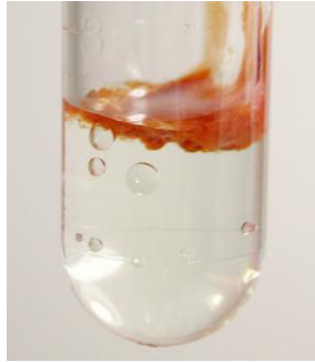
Figure 6 : précipité brun-orangé résultant du mélange de NaOCl et CHX (source : Basrani et Haapasalo 2012)
