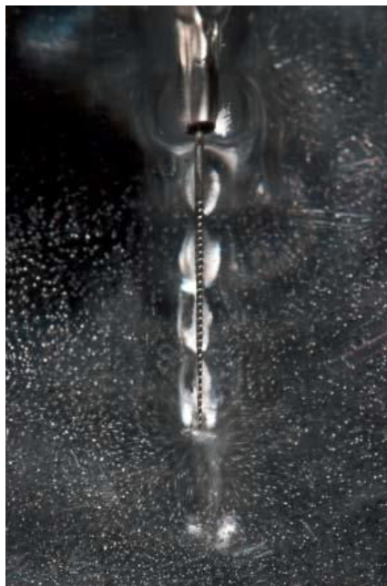
Figure 28 : mise en évidence des phénomènes hydrodynamiques le long de l'insert Irrisafe® (source : http://www.support-acteon-equipment.com )
