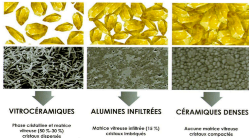
Figure 10 : Microstructure des céramiques dentaires (source : Étienne et coll, 2016).
