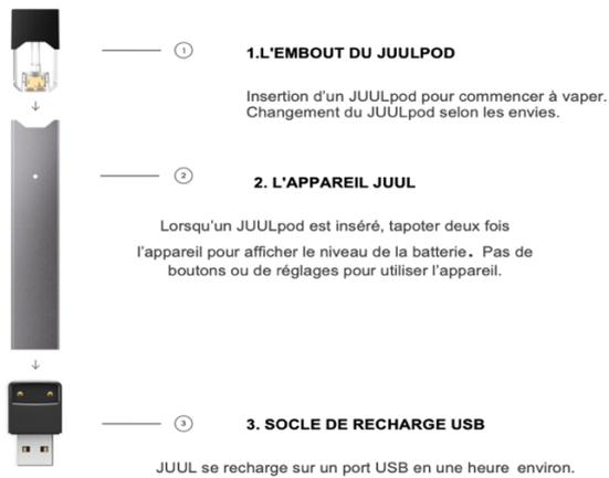
Figure 3 : Schéma illustratif de la composition et du mode de fonctionnement d'une cigarette électronique JUUL. (Source JUUL)
