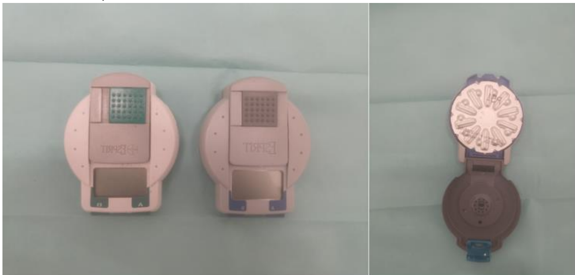
Figure 29 : Photographie de 2 modèles d'Esprit Glucomatic 2 ® la forme ronde s'explique par le chargeur à l'arrière qui contient un disque de 10 électrodes
