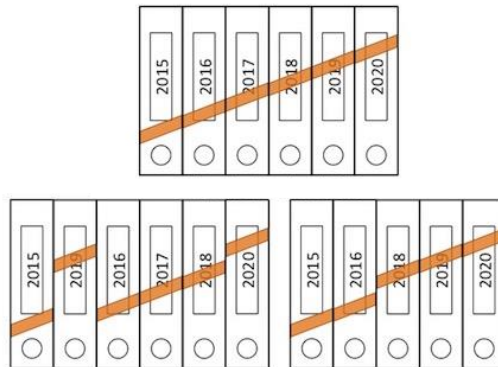
Figure 6 : Exemple d'application du 5S : marquage des classeurs avec un trait de couleur, extrait de C.Hohmann, 2012 [19].
