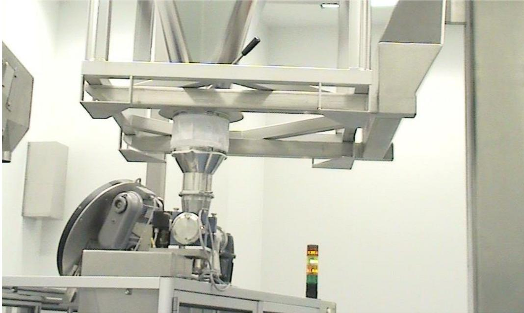
Figure 23: Photographie de la sortie du conteneur relié à la vis d'alimentation par une chaussette.
