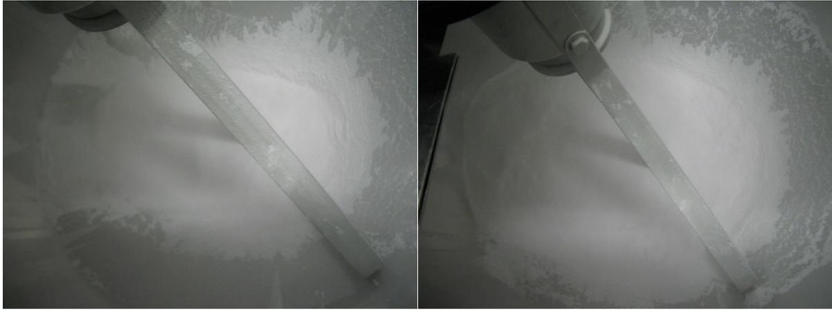
*Figure 30: photographies de l'intérieur de la trémie après un arrêt manuel de son alimentation.*
