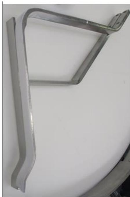
*Figure 63 : Photographie des pales d'agitation. Dessous : pale de la nouvelle configuration, dessus : pale de l'ancienne configuration.*
