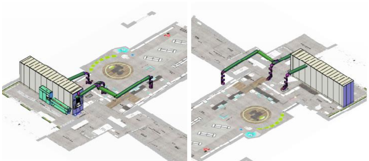
Figure 9 Modélisation 3D du robot et de sa transitique
