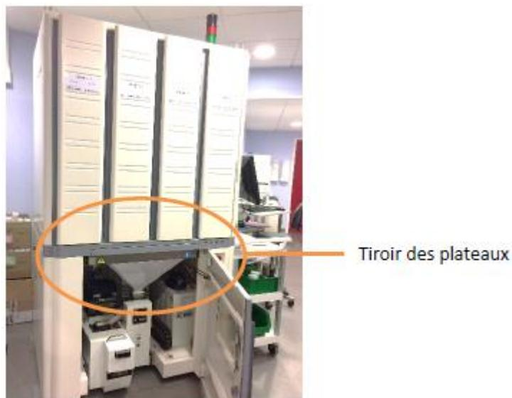
Figure 15 : Zone d'insertion des plateaux dans l'automate
