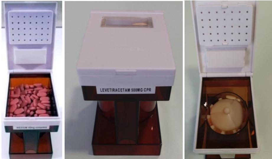
**Figure 16 : Canisters calibrés dédiés à une seule spécialité précise**
