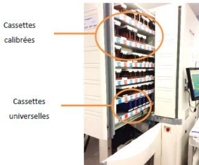
**Figure 18 : Emplacement des canisters au sein de l'automate**
