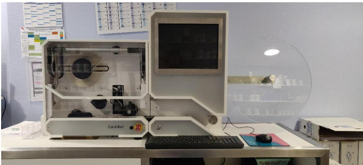
**Figure 20 : Automate de contrôle optique : Pouch Inspector®**
