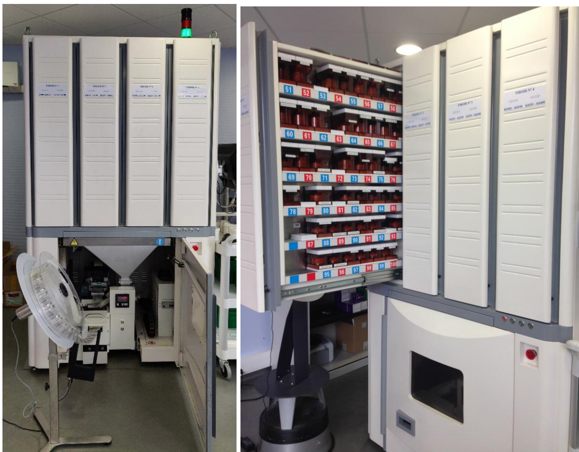
Figure 8 : Automate de reconditionnement Unidose® de la société MACH4 Omnicell®
