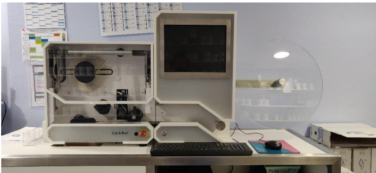
Figure 20 : Automate de contrôle optique : Pouch Inspector ®
