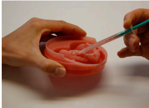
Figure 21 : Mise en place de la colle dans les alvéoles. [22]
