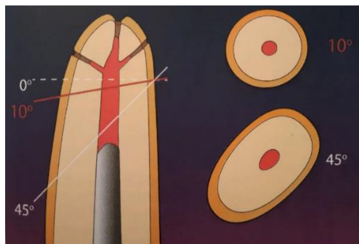
Figure 29 : Un angle de résection de 45° entraîne une exposition supérieure des tubules dentinaires. Ce qui augmente les risques de percolation de bactéries en post-opératoire (source : Kim et Kratchman 2018).
