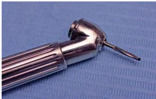
Figure 26 : pièce à main chirurgicale à grande vitesse angulée à 45° avec une fraise Lindemann (source : Chong et Rhodes 2014).
