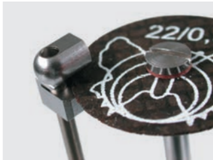
Figure 39 : Découpe du tube à la longueur déterminée (Source : Cendres+Métaux, 2015)
