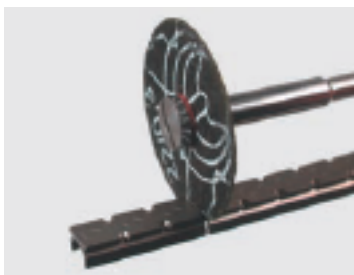
Figure 48 : Découpe de la partie femelle
