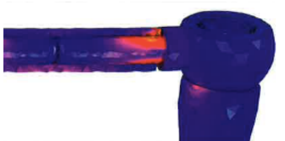
Figure 32 : Distribution des contraintes au niveau du raccord grande articulation et extrémité du tube (Source : Deslis et coll., 2012)
