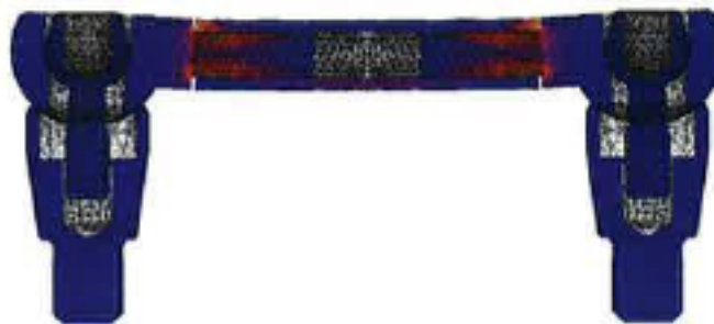
Figure 31 : Etude de la distribution des forces dans le système SFI-Bar® (Source : Deslis et coll., 2012)
