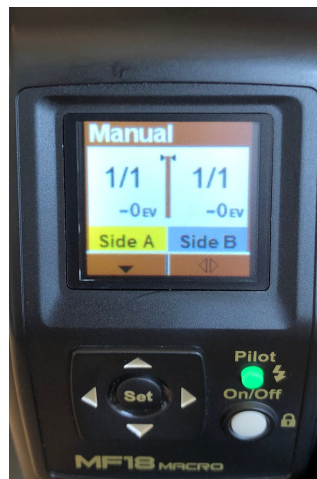
Figure 67 : Réglage d'un flash Nissin® MF18 en mode « manuel » garantissant une émission lumineuse maximale de 1 :1, sachant que le filtre polarisant ne permet que le passage de 38 à 42% de la lumière. (Source : document personnel)
