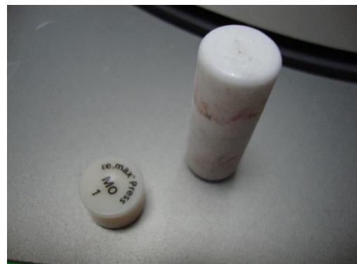
Figures 9 et 10 : Pressée d'un lingotin de céramique IPS e.max® Press MO (moyenne opacité). Le piston recouvre le lingotin placé dans le cylindre en matériau réfractaire (illustrations personnelles)
