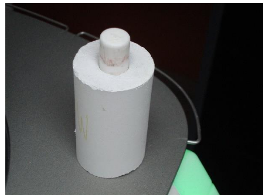
Figures 35 et 36 : Lingot de céramique IPS e.max® Press MO utilisé lors de la pressée des infrastructures et piston de pressée (illustrations personnelles)
