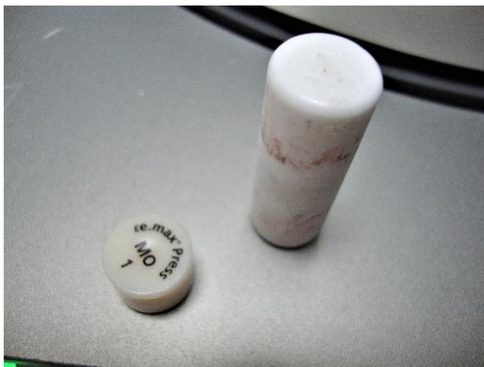
Figures 35 et 36 : Lingot de céramique IPS e.max® Press MO utilisé lors de la pressée des infrastructures et piston de pressée (illustrations personnelles)
