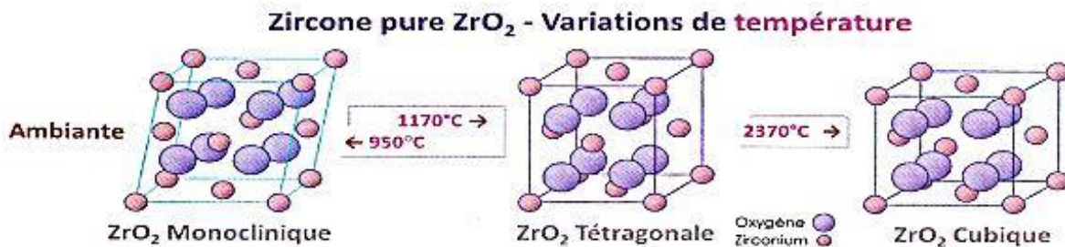
Figure 5 : Microstructure cristalline de la zircone en fonction de la température (en °C) (46)
