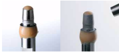
Figure 37 : Embase titane, avant et après sablage, protégée par de la cire dure (Source : Ivoclar-Vivadent®)
