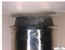
Figure 56 : Rupture adhésive du joint de colle (Source : Gerkhe et coll)
