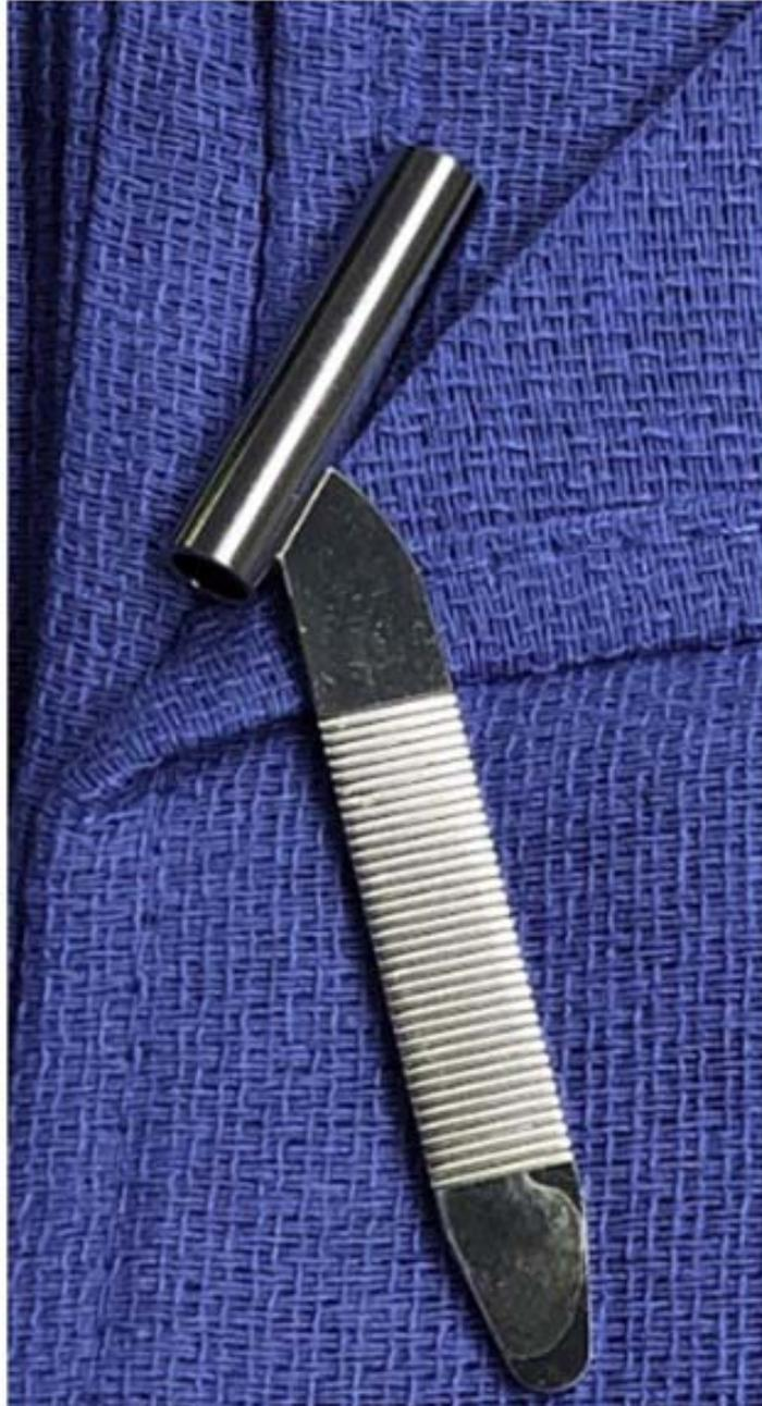
Figure 12 : manchon de protection utilisé avec forets (source : Rosenstein J. et coll, 2020)
