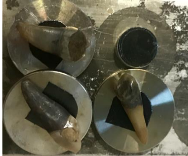
Figure 39 : dents n°33, 45 et 36 recouvertes d'une couche de carbone après métallisation (source : donnée personnelle, 2019)
