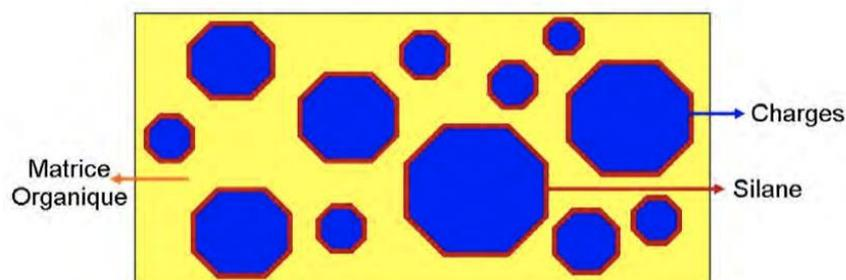
Figure 27 : Représentation schématique d'une résine composite (source : Chaumont, 2012)
