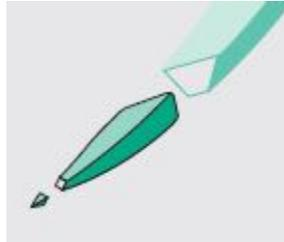
Figure 27 : Schéma explicatif d'une aiguille en pointe à spatule
