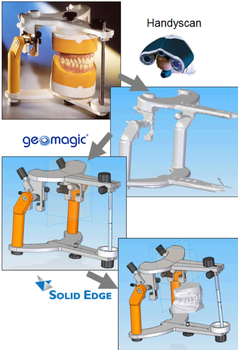
Figure 40 : Processus de modélisation de l'articulateur Stratos 200 (source : Solaberrieta et coll., 2009)
