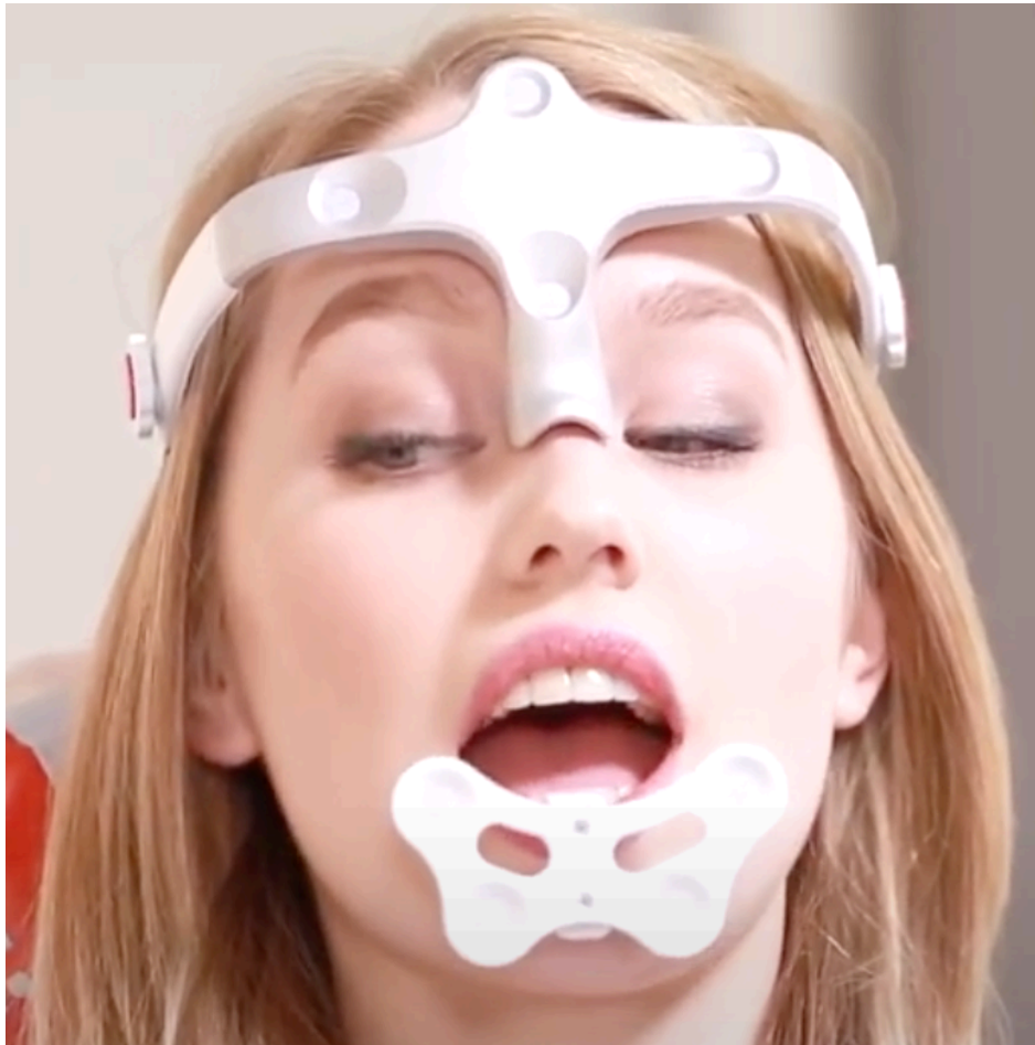
Figure 67 : Ensemble des trackers (cibles) fixés sur les parties fixes du crâne et sur les dents mandibulaires mobiles. [4]
