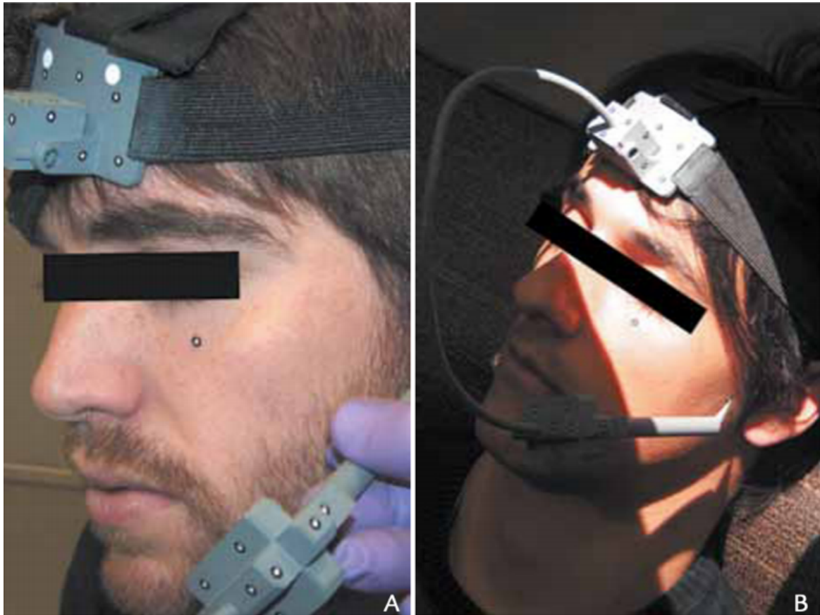
Figure 18 : Scannage des points. A gauche : pointeur placé sur le point de l'articulation temporo-mandibulaire gauche. A droite : Scannage du pointeur et des parties fixes dans la même position (source : Solaberrieta et coll. 2013)
