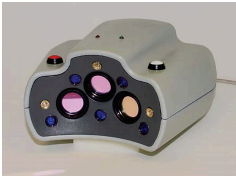
Figure 53 : L'unité d'imagerie portable mesure environ 15 cm de large et 15 cm de profondeur, et le bouton blanc active les lumières bleues et les lasers rouges, qui
