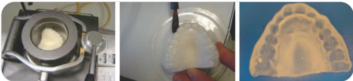
Figure 36 : Silicone plaqué sur le moule en plâtre par dépression (a), puis découpe de la plaque (b) afin d'obtenir le résultat définitif (c) [118]
