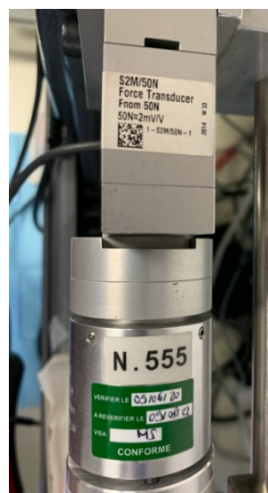
Figure 26. Cellule de force montée sur le banc d'essai (Source : document personnel).
