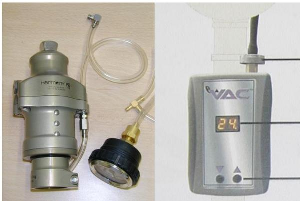
**Figures 9** : Système de dépressurisation
