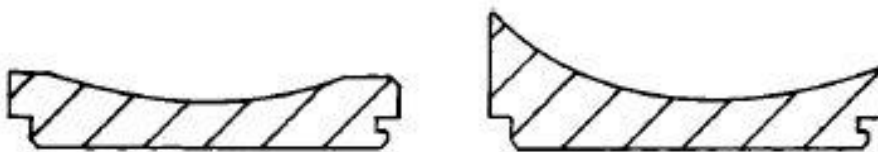
Hofmann (12) : comparaison du profil d'un insert standard et ultra congruent deep dish
