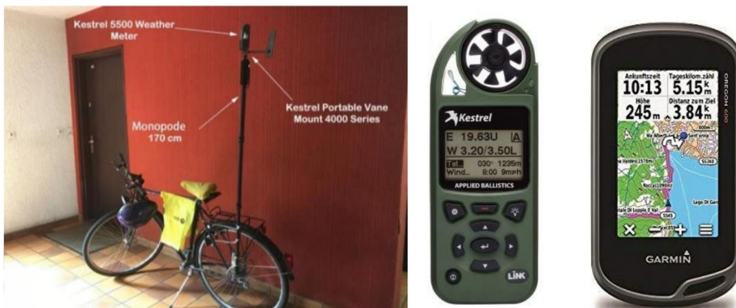
Figure 2 : Vélo équipé des instruments de mesure (gauche), station Kestrel 5500 (centre) et GPS Garmin.600 (droite).
