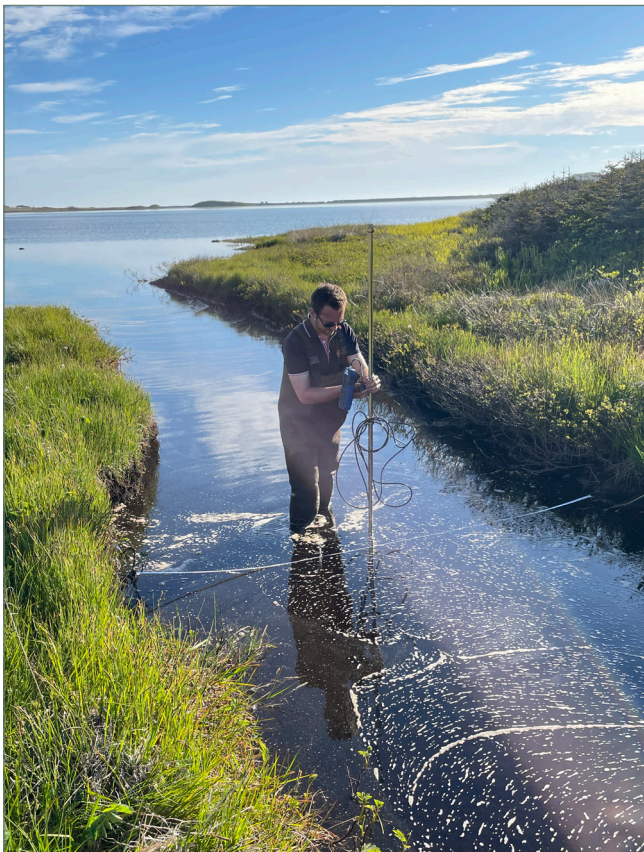
Figure 4 : Le ruisseau de Savoyard à son débouché dans l'étang de Savoyard (île de Saint-Pierre). Jaugeage au courantomètre OTT. Cliché Edgard Gustave, 8 juin 2021.
