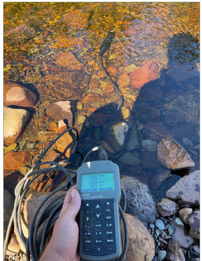
Figure 5 : Mesures physico-chimiques réalisées avec une sonde multiparamétrique Hanna HI 98194 (ruisseau de la Belle Rivière). Cliché Edgard Gustave, 25 juin 2021.
