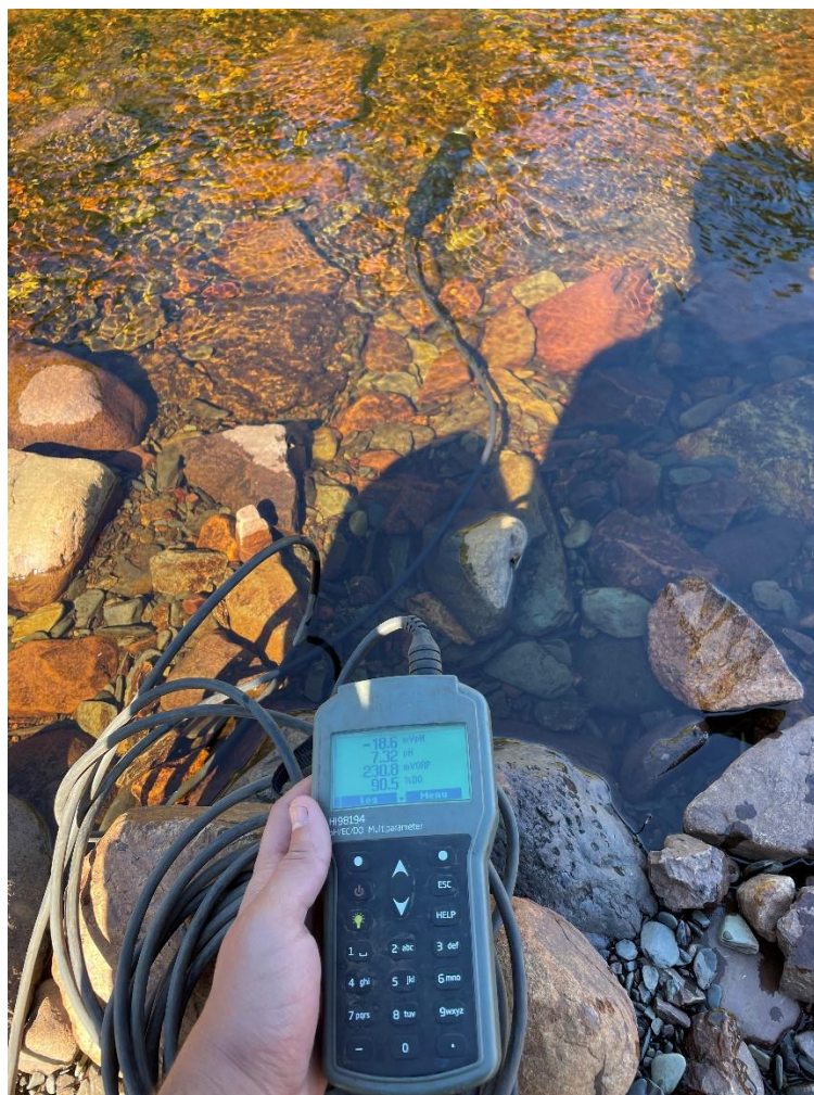
Annexe 29. Mesures physico-chimiques avec la sonde multiparamétrique Hanna HI 98194 (ruisseau de la Belle Rivière). Edgard Gustave, 25/06/2021.
