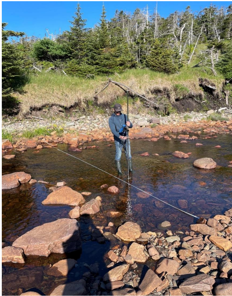
Annexe 24. Maniement de la perche courantométrique MF Pro sur une section de la Belle Rivière. Edgard Gustave, 25/06/2021.
