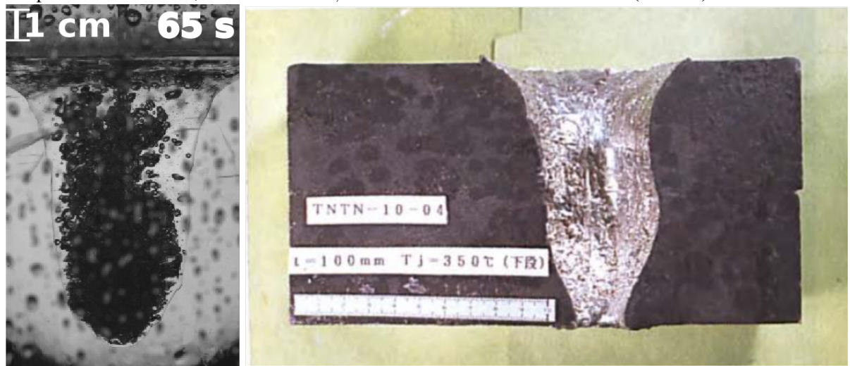
FIGURE 8 – Comparaison entre une photographie de la cavité pendant le « pool-effect » après 65 s d'impact pour le test avec de l'eau à 23 °C, un diamètre de jet de 3,2 mm et une vitesse de 5,7 m.s -1 (à gauche) et une photographie de la cavité obtenue par Sato et al. [7] lors d'un jet étain/étain d'une température de 350 °C, une vitesse de 4,8 m.s -1 et un diamètre de 10 mm (à droite).
