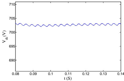
Fig. 17. DC bus voltage.
