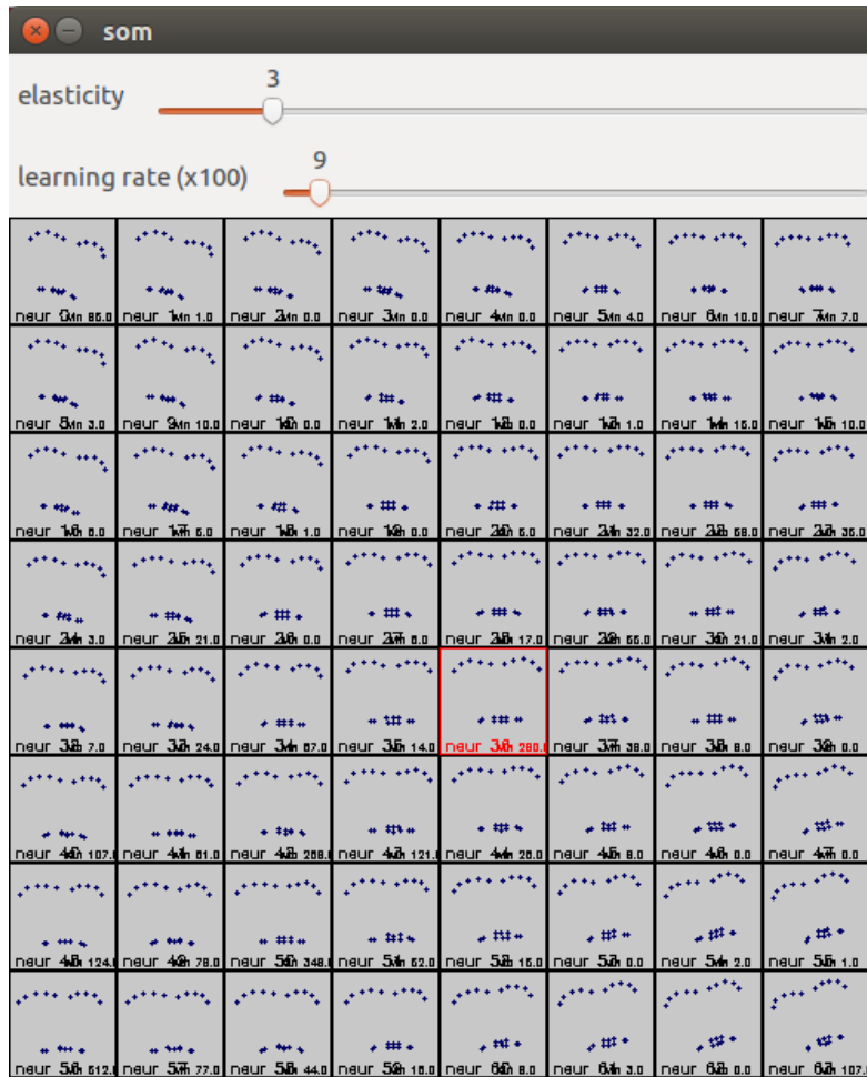
Figure 6: Une carte DSOM avec 64 (8x8) neurones. Chaque neurone est représenté par son prototype (points bleus) dans l'espace des images. L'auto-organisation permet de s'assurer que deux neurones proches (au sens de la topologie de la carte) possèdent des prototypes proches (au sens de la distance entre prototypes). Dans l'exemple montré ci-dessus, les neurones dans les coins supérieur gauche et inférieur droit sont opposés, mais il existe un chemin continu dans la carte permettant de passer de l'un à l'autre). Le paramètre d'élasticité permet de contrôler la similitude entre les prototypes de deux neurones voisins.
