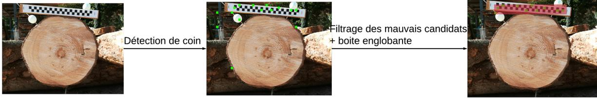
FIGURE 9 – Illustration de la méthode de segmentation basé sur de la détection de coin.
