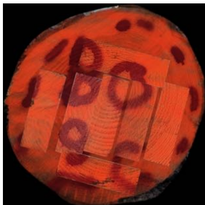
FIGURE 25 – Billon avec des planches orthogonale au meilleur angle
