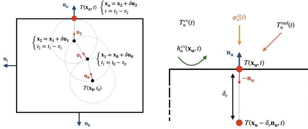
(a) Marche aléatoire en conduction selon le principe de Walk on Sphere à pas constant  $\delta$  [15]. Le chemin a démarré au point  $\mathbf{x}_0$  à l'instant  $t_0$  et a atteint la surface supérieure à la position  $\mathbf{x}_u$  à l'instant  $t$ .
