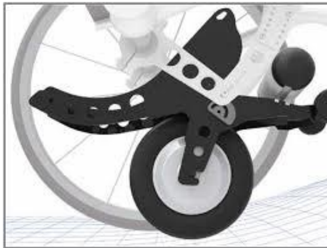
Figure 11 : Vue latérale du système YOMPER. La roue centrale est amortie et est équipée d'un pneumatique. L'installation des rails prend une quinzaine de minutes. La mise en place et le retrait du dispositif prend quelques secondes moyennant une poignée
