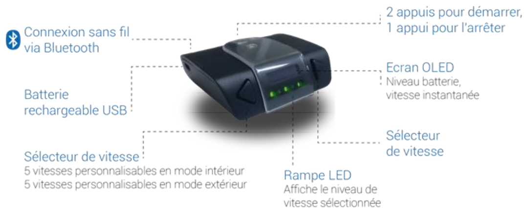
Figure 13 : Détails du boîtier amovible, attaché sur l'utilisateur grâce à une sangle velcro. Il permet de contrôler et modifier certains paramètres via une connexion sans fil, ainsi que de démarrer et arrêter le moteur
