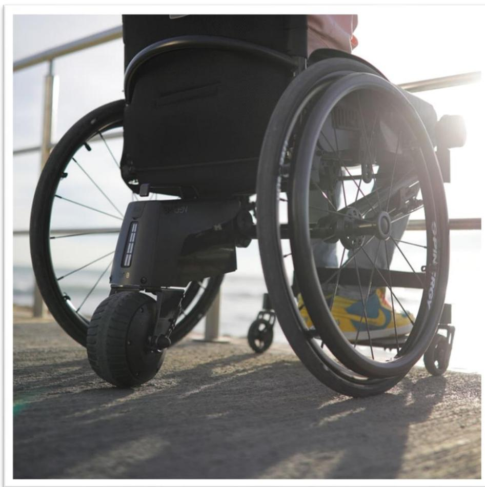
*Figure 2 : Photographie en situation d'un exemple d'AEP de type « troisième roue centrale »*
