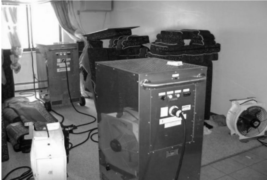
FIGURE 58 : TRAITEMENT THERMIQUE D'UNE PIECE ENTIERE AVEC UN GENERATEUR DE CHALEUR ELECTRIQUE (DOGGETT ET AL, ADVANCES IN THE BIOLOGY AND MANAGEMENT OF MODERN BED BUGS, 1ERE EDITION, JOHN WILEY & SONS ED. 2018)
