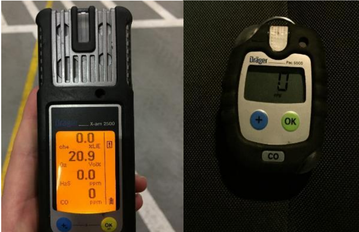
Figure 21 : Détecteur multi gaz du fourgon (à gauche),détecteur CO à demeure sur le sac d'oxygénothérapie (à droite) (collectio personnelle) [73]
