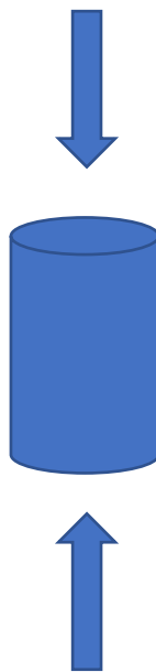
Figure 13 : Schéma représentant la force de compression (source : document personnel)
