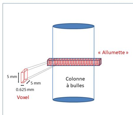
Figure 5 : Définition des profils 1D horizontaux « en allumette »
