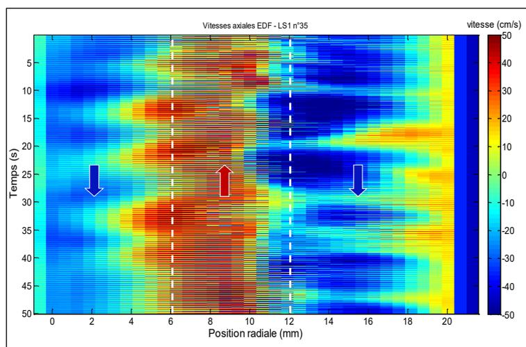
Figure 8 : Carte de vitesse axiale  $V_z(x,t)$  de l'eau dans une colonne à bulles de diamètre intérieur 22 mm. Les pointillés en blanc délimitent la zone de passage des bulles conformément à la figure 6. Les flèches en rouge et en bleu indiquent respectivement le mouvement moyen ascendant de l'eau au voisinage des bulles et descendant sur les bords de la colonne.
