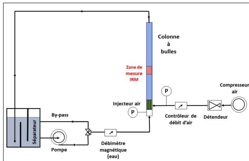
Figure 9 : Schéma de la boucle ROMANE.
