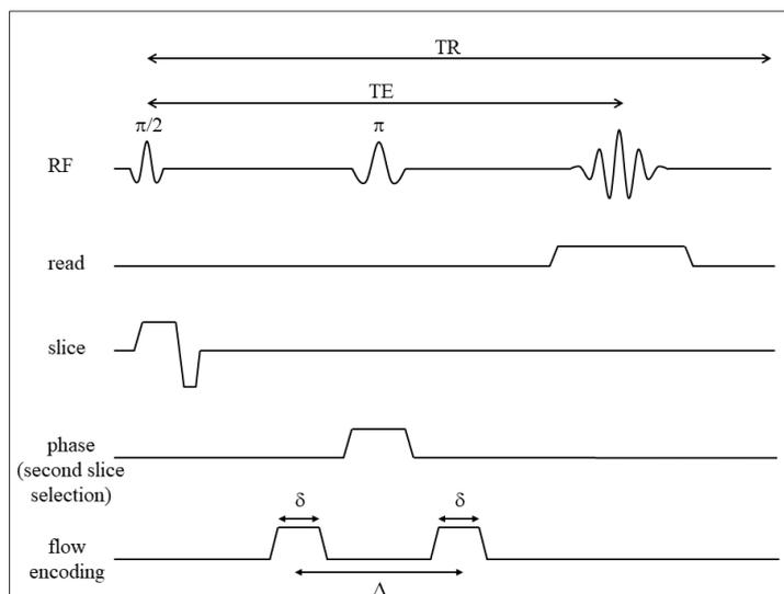
Figure 7 : Séquence d'écho de spin rapide avec double sélection de tranche (en allumette). Les 2 impulsions de gradient ('flow encoding') permettent de réaliser l'encodage de phase.
