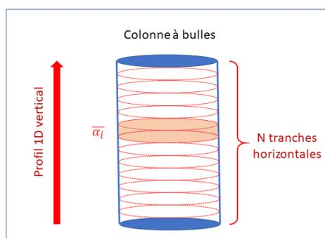
Figure 2 : Définition des profils 1D verticaux.
