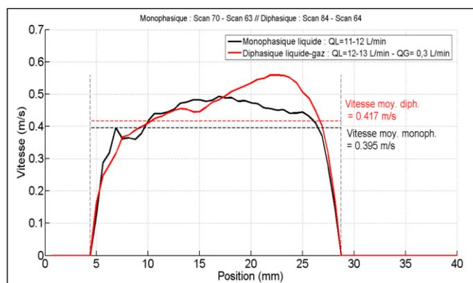
Figure 12 : Profils-1D horizontaux de vitesse  $V_z(x)$  obtenus par IRM. En noir : monophasique - Débit liquide  $Q_L \approx 12$  L/min. En rouge : diphasique - Débit liquide  $Q_L \approx 13$  L/min. Débit gaz  $Q_G = 0,3$  NL/min. Les lignes pointillées verticales matérialisent les bords du tube. Les traits pointillés horizontaux donnent les vitesses moyennes calculées à partir de ces profils.
