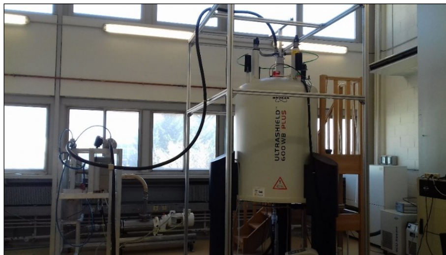
Figure 10 : Photo de la boucle ROMANE traversant le spectromètre RMN.
