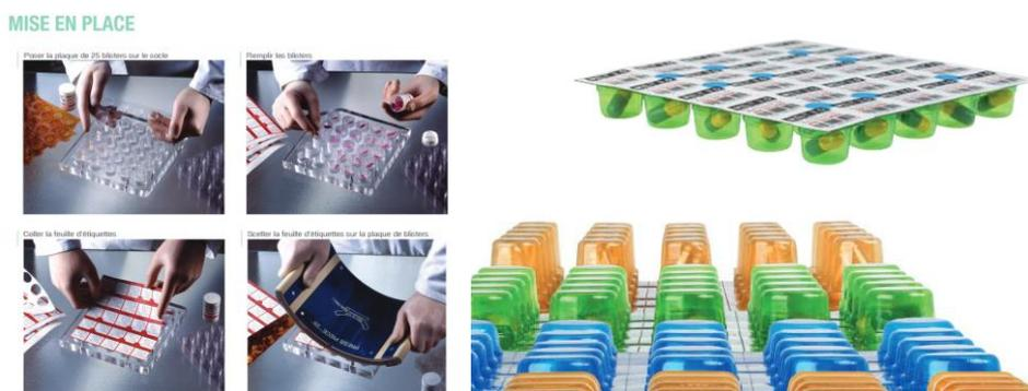
FIGURE 6 : EXEMPLES DE MEDIDOSE® DE PER'OS® (MODE OPERATOIRE ET BLISTERS)
