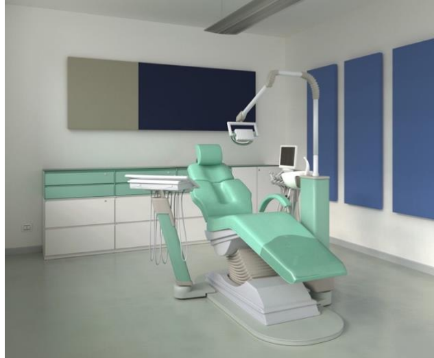
Figure 17: Panneaux muraux dans une salle de soins (d'après le site https://carusoacoustic.com/fr/inspiration/absorption-acoustique-cabinets-dentaires/ )
