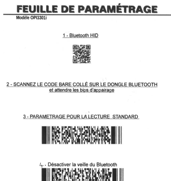
Figure 26 : paramétrage du lecteur optique pour l'appairage avec la clé USB fournie par le fabricant
