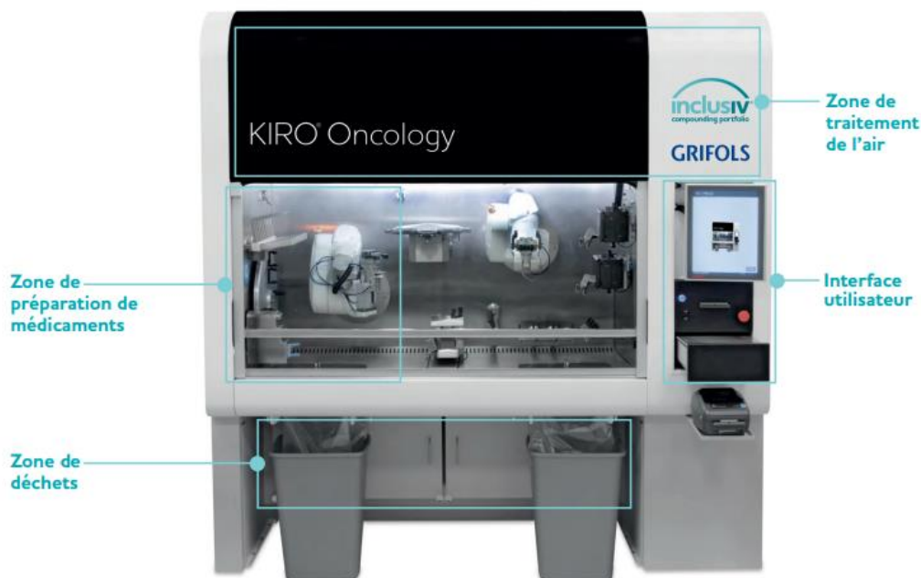
Figure 12 : Zones délimitées de l'automate Kiro Oncology® placé sous une hotte
