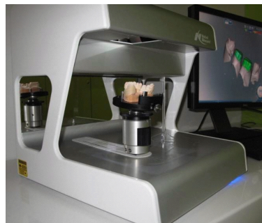
Scannage du modèle de travail physique par holographie conoscopique
