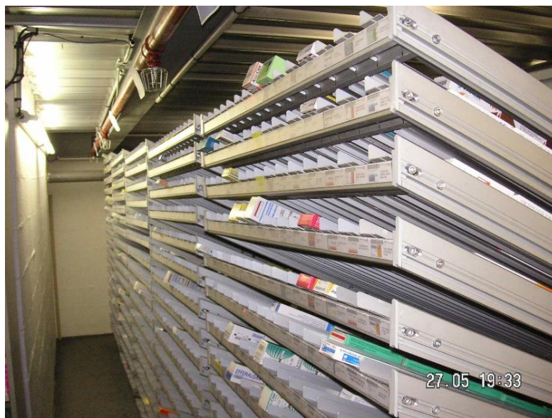
Figure 10 : Goulottes d'un automate. Issue du site internet http://j-f.russo.pagesperso-orange.fr/ de la pharmacie Russo à Evry. Photographie de leur automate APOTEKA 2 commercialisé par la société Mékapharm®.
