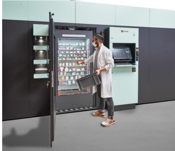
Figure 28 : Schéma d'une porte de chargement semi-automatique. Issue du site internet omnicell.fr . Photographie illustrant la porte de chargement semi-automatique « Fill-in-door » intégrée dans le robot MEDIMAT proposé par l'entreprise Omnicell®.
