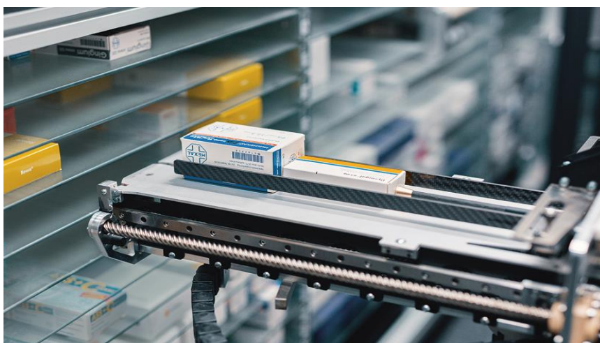
Figure 17 : Tête de bras d'un robot effectuant un multipicking. Issue du site internet rowa.de. Photographie illustrant le robot VMAX proposé par le fabricant BD ROWA™.
