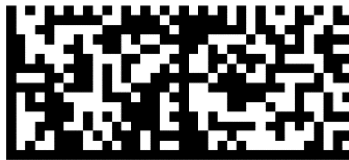
Figure 4 : Data Matrix rectangulaire à matrice de 12x36. Illustration issue du Cahier N°1 CIP-ACL « DATA MATRIX : Support de la traçabilité du médicament, caractéristiques techniques », Club Interpharmaceutique.
