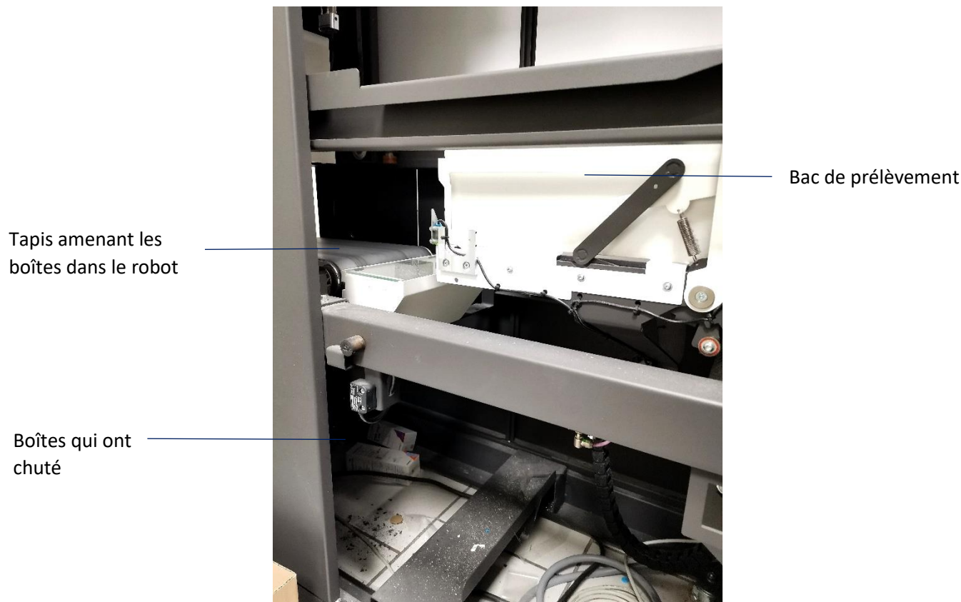
Figure 2 : boîtes tombées en bas du module de chargement automatique
