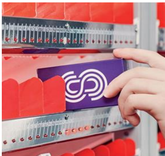
Figure 12 : Indicateur LED de chargement. Issue de la brochure de présentation de l'automate TwinTech proposée par le fabricant Swisslog Healthcare®, site internet : swisslog-healthcare.com
