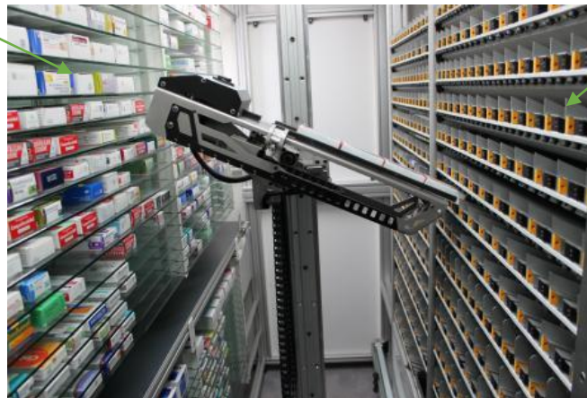
Figure 18 : Schéma d'un robomate. Issue du magazine « Le quotidien du Pharmacien », article « Une machine 100% robot chez Pharmax » publié le 10/07/2014, illustrant l'hybride RG2 Ultra proposé par Pharmax®.
