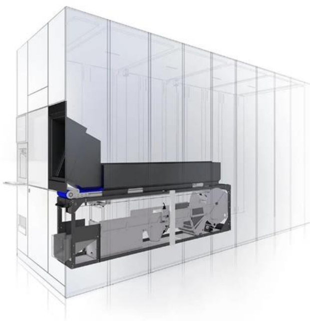
Figure 27 : Schéma d'un bac de chargement automatique intégré au robot. Issue du site internet meditech-pharma.com . Illustration de leur bac de chargement automatique MT.INTEGRATED pouvant être intégré dans les robots MT.XS et MT.XS .
