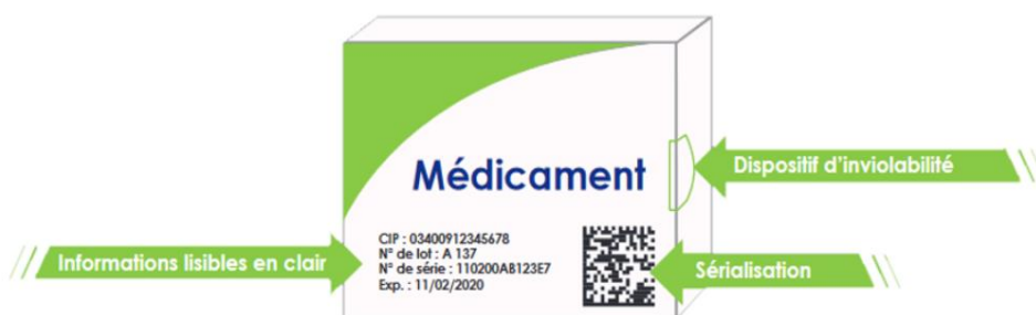
Figure 7 : Dispositifs de sécurité prévus par la directive 2011/62/UE du 8 Juin 2011. Issue du Site internet PHARMAGEST ( https://pharmagest.com/quest-ce-que-la-serialisation/ )
