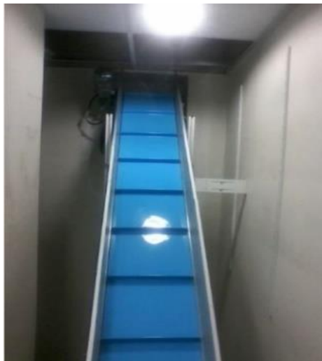
Figure 24 : Schéma d'un tapis montant à tasseaux. Issue de la brochure « Le convoyage by MEKAPHARM », disponible sur le site internet mekapharm.com.
