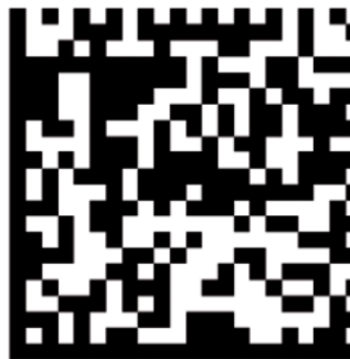
Figure 5 : Data Matrix carré à matrice de 22x22. Illustration issue du Cahier N°1 CIP-ACL « DATA MATRIX : Support de la traçabilité du médicament, caractéristiques techniques », Club Interpharmaceutique
